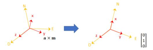
$$\begin{bmatrix} r_{11} & r_{21} & r_{31} \\ r_{12} & r_{22} & r_{32} \\ r_{13} & r_{23} & r_{33} \end{bmatrix} \begin{bmatrix} 0 \\ 1 \\ 0 \end{bmatrix} = \begin{bmatrix} a_1 \\ a_2 \\ a_3 \end{bmatrix} \times \begin{bmatrix} m_1 \\ m_2 \\ m_3 \end{bmatrix}$$
